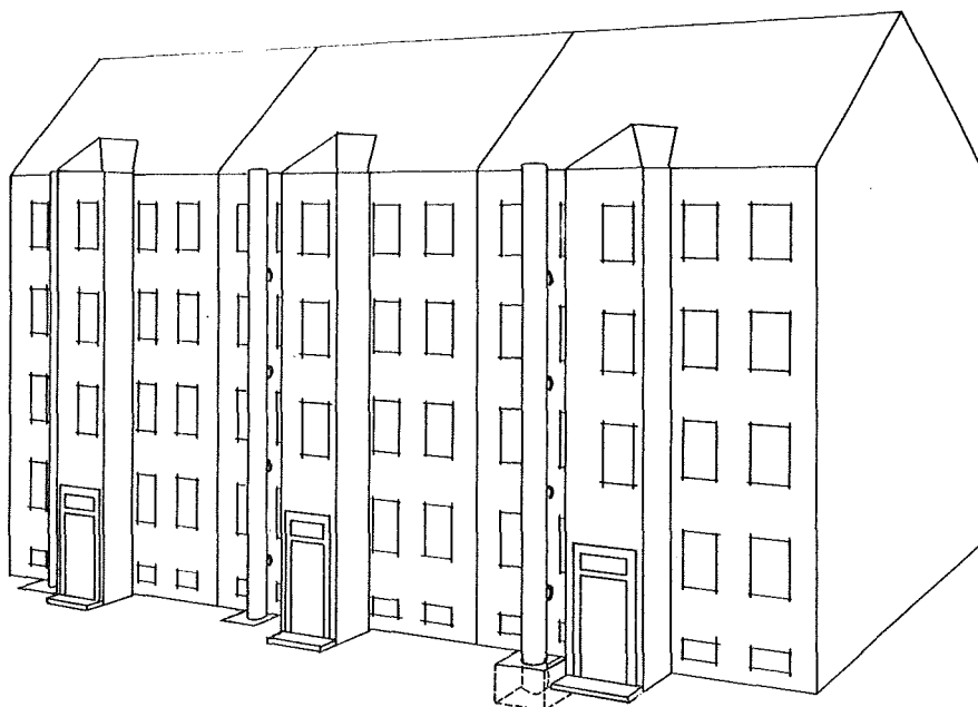
Figur 7.2. Basisinstallationen monteret i rør på husets gårdfacade.
